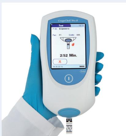
1. Mise en marche automatique lors de l'insertion de la bandelette réactive
