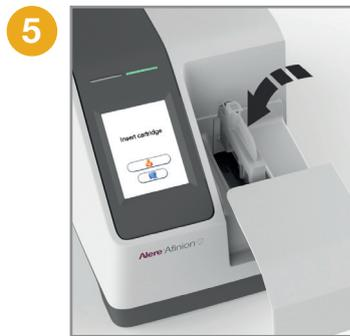
5 Insérer soigneusement la cassette de dosage avec le code-barres à gauche.
