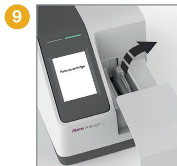
9 Retirer et jeter immédiatement la cassette de dosage utilisée. Fermer le couvercle manuellement lorsque l'analyseur n'est pas utilisé.
