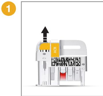
1 Dégager le dispositif d'échantillonnage de la cassette de dosage en tirant vers le haut.
